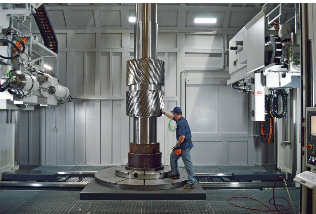
3 Blick in den Innenraum der LC 4000 mit Werkstück © Liebherr
