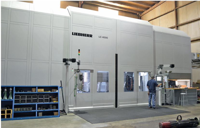
2 Wälzfräsmaschine LC 4000: riesige Dimensionen für riesige Zahnräder © Liebherr
